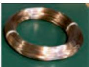
Glänzende Oberfläche (Ziehen mit flüssigem Schmiermittel mittels Diamant-Ziehstein)
