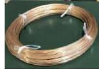
Surface semi-brillante (tréfilage avec lubrifiant poudré à travers une filière carbure)
