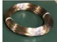
Surface brillante (lubrifiant liquide à travers une filière diamantée)
